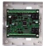
Contrôleur de porte pour 2 lecteurs de badge Wiegand • entrées pour état de porte et sortie pour commande de gache • max. 1000 Utilisateurs • Lecteur format wiegand universel, jusqu'à 40 bits • Dimensions : 175 x 155 x 30 mm
